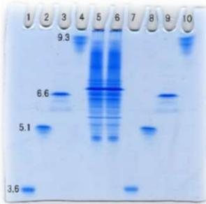
ポリアクリルアミド等電点ゲルに最も適したServalyteを採用、可溶性タンパク質を精細に分離することができます。別売のIEF3-10またはIEFpH3-7バッファーキットを使用して泳動します。染色にコロイドCBB染色キットを使用すれば低バックグラウンドな結果が得られます。レーンを切出して2次元泳動を行うこともできます。
